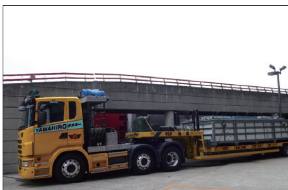
図3. 陸送トレーラーに載せたジンベエザメ専用輸送容器
