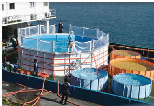
図5. 輸送船上に設置した輸送水槽 (約80 \text{m}^3 ) とターポリン水槽 (10 \text{m}^3 1基、5 \text{m}^3 3基)
